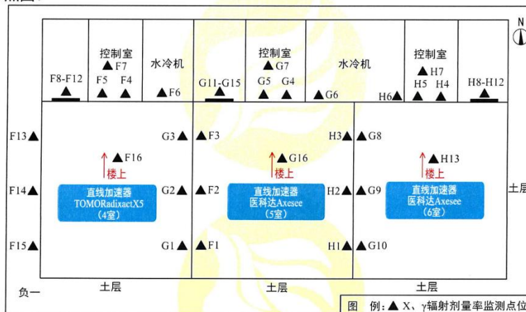
图 3 河北医科大学第四医院医疗综合楼(河北省癌症中心主楼)医用电子直线加速器及血管造影用 X 射线装置应用项目周围环境 X、 \gamma 辐射剂量率监测点位示意图
