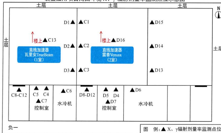
图 2 河北医科大学第四医院医疗综合楼(河北省癌症中心主楼)医用电子直线加速器及血管造影用 X 射线装置应用项目周围环境 X、 \gamma 辐射剂量率监测点位示意图
